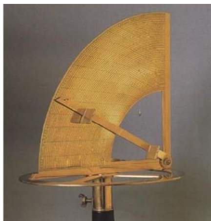
Figura 9: Réplica de instrumento com o nónio de Nunes
