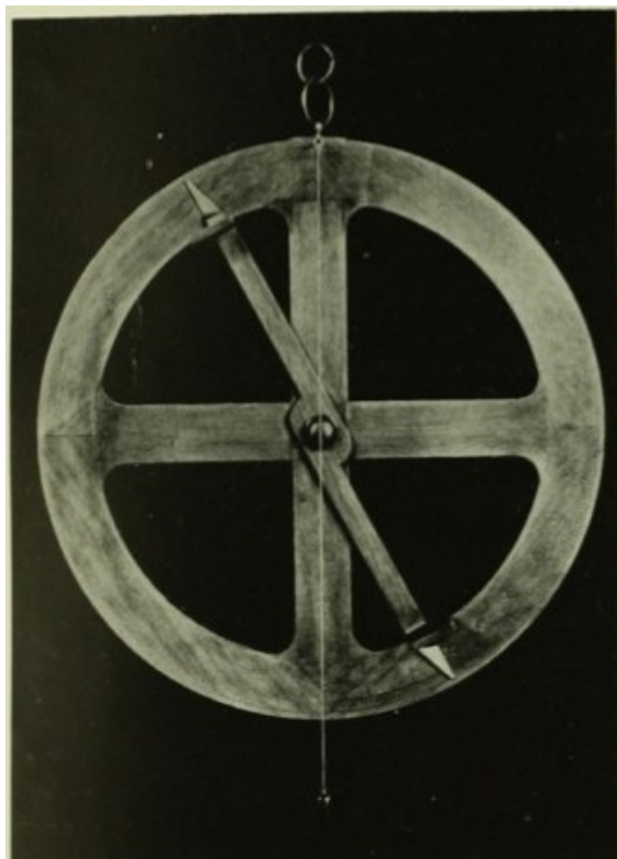
Figura 1: Réplica de astrolábio, construída no Instituto Superior Técnico
