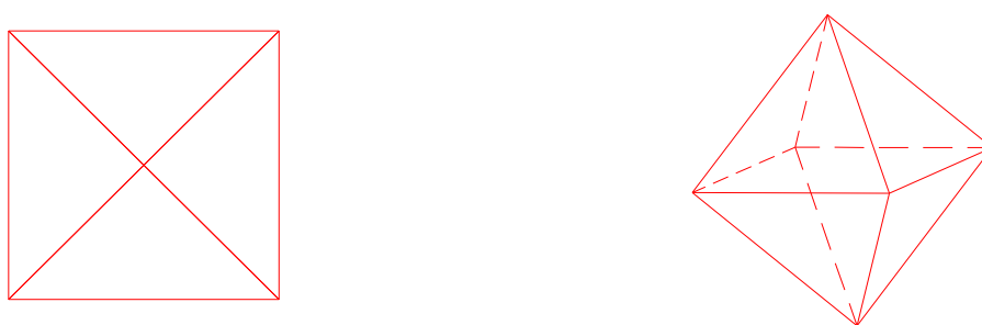
Fig. 1: Representações de um octaedro regular. O desenho à esquerda corresponde a uma vista obtida por uma projeção ortogonal segundo seu eixo na simetria quaternária e o desenho à direita ilustra uma vista obtida por uma projeção ortogonal com os eixos de simetria do objeto oblíquo ao plano em que este foi projetado.
